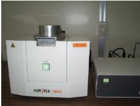
アワーズテック社製 エネルギー分散型蛍光X線分析装置
