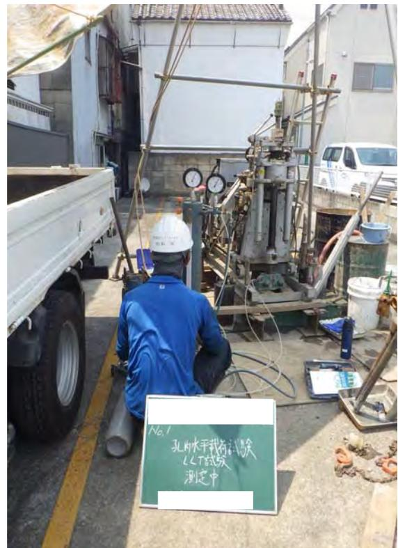
孔内水平載荷試験 測定中
