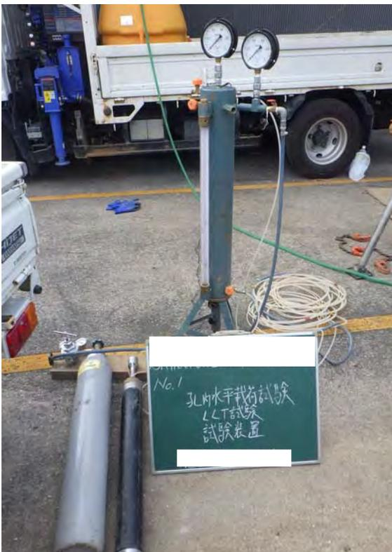
孔内水平載荷試験 試験装置
